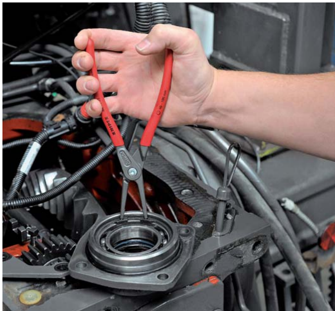
Stabiele ingezette punten van speciaal veredeld verenstaal
