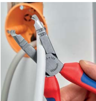
Snijden van kabels tot Ø 13 mm
