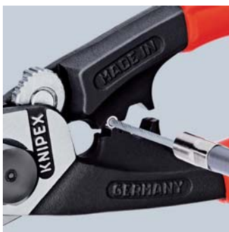
De eindhulzen op de trekkabel persen
