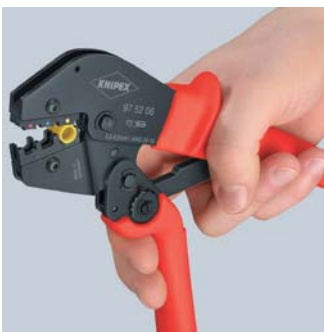
Eerste stap: knijp de benen met twee vingers samen, tot de twee beken de te krimpen verbinder raken
