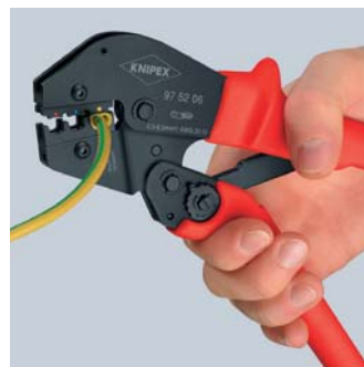
Tweede stap: vanaf nu voor de verdere verkrimping de hele hand gebruiken
