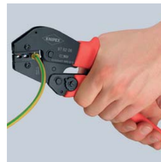
Derde stap: wanneer meer kracht is vereist, v.b. bij geïsoleerde verbinders 6 mm 2 is dankzij de langere handgrepen is bediening met twee handen mogelijk
