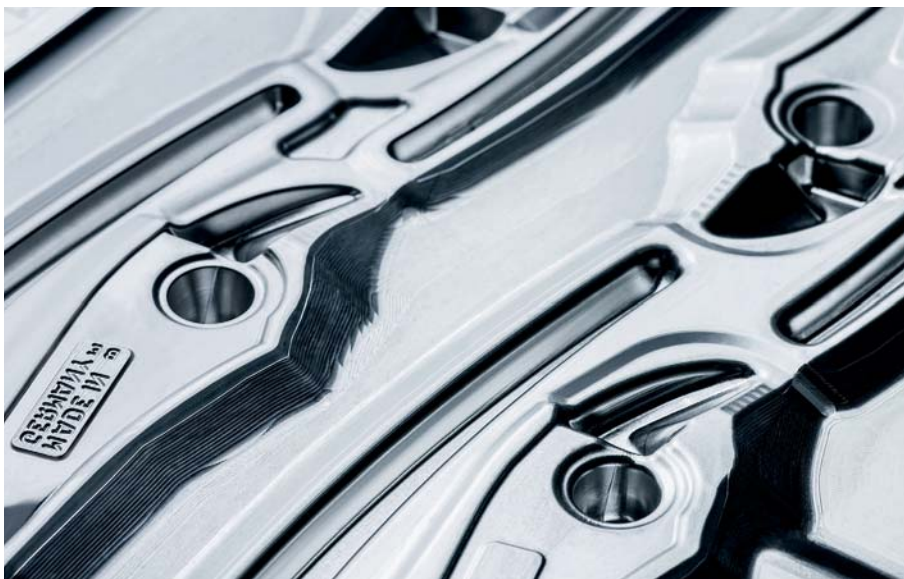
Smeedstuk voor de kracht-zijnsnijder met gesmede scharnieras.
