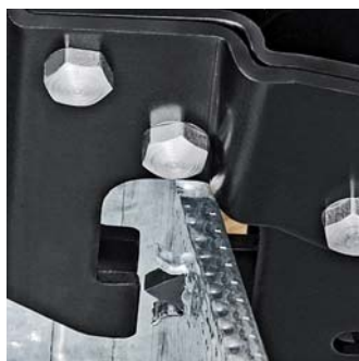
Het ponsgereedschap wordt door de plaat gedrukt
