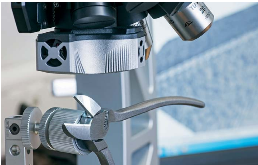
Bij de zijnsnijder worden de vorm en de ruwheid van het lemmet met een optisch 3D-meetsysteem precies gemeten.
