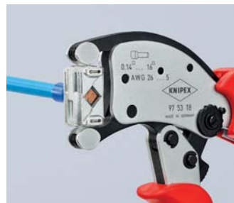
Eenmalig flexibel: verbinders kunnen vanuit praktisch elke positie in de draaibare krimpkop gevoerd worden
