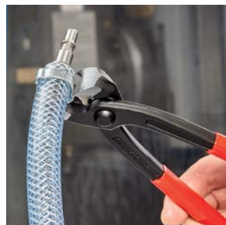
Afdichten pneumatische slang aan snelkoppeling door middel van voorkant van de tang om te persen
