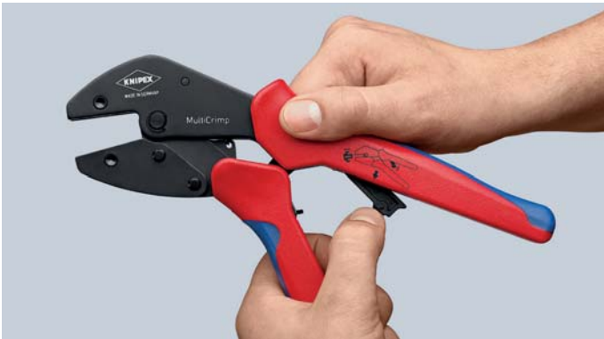
Wisselpositie: uitklappen van de positioneringspal voor parallelle bekkenpositie
