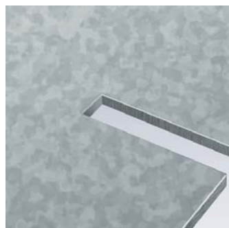
Uitklinken en spaanbreken in één enkele beweging
