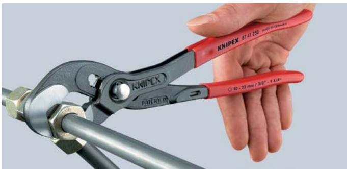
Zelfklemende functie verhindert dat de tang wegglijdt en vereist minder kracht
