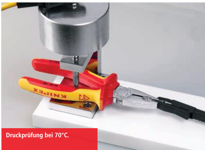
Prüfung der Haftfähigkeit der VDE-Hüllen mit 500 N.
