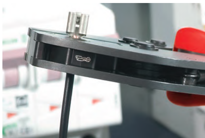
Gut sichtbare Kennzeichnung der Crimpeinsätze mit Piktogrammen
