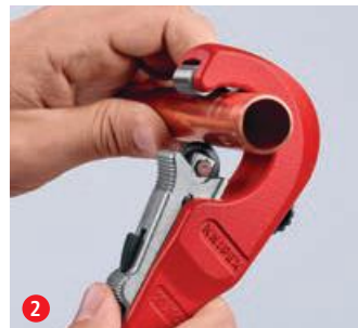
2 Schneidrad mit QuickLock-Einhandschnellverstellung ans Rohr schieben: schnelle Einstellung an unterschiedliche Rohrdurchmesser
