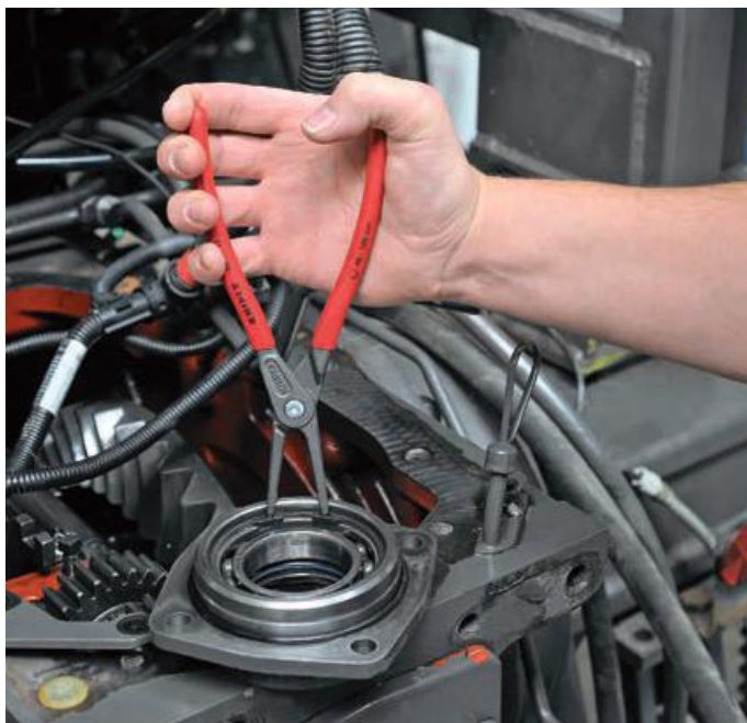
Stabile, eingesetzte Spitzen aus hochverdichtetem Federstahl
