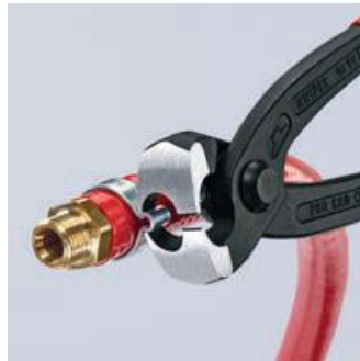
Abdichten Fluidschlauch an Stutzen mittels Seiten-Pressnase
