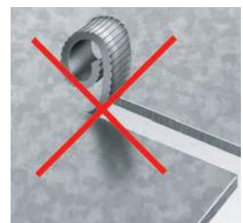
Ausklinken ohne Spanbrecher
