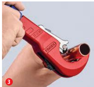
3 Durch Drehung schneiden und dabei mit dem ergonomischen blauen Drehknauf nachstellen ...
