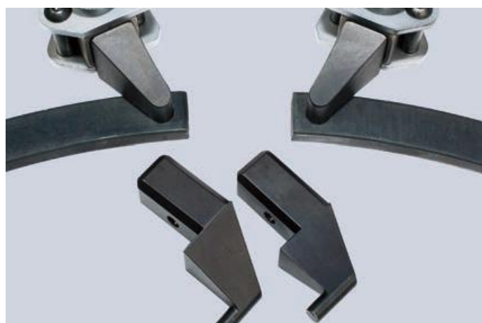
Wechselbare Einsätze für Innen und Außenringe
